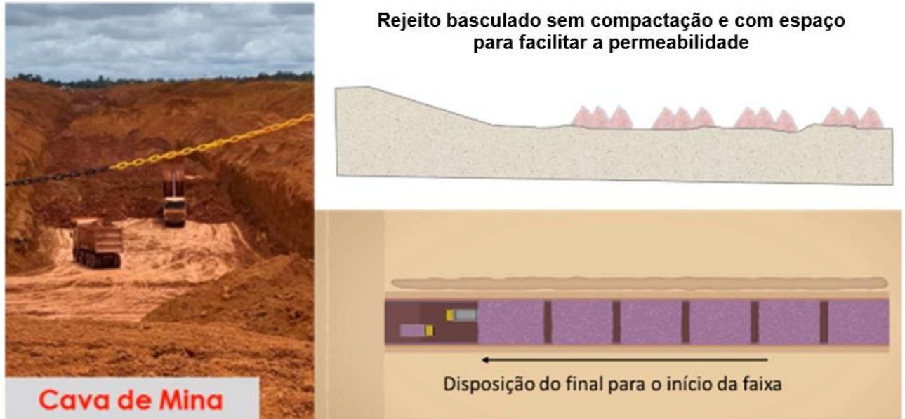
Figura 120 – Ilustração esquemática da disposição de rejeito em fundo de cava
