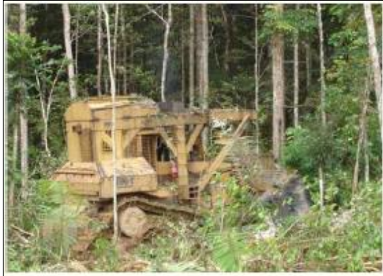
Figura 7 – Registro da operação de supressão vegetal com emprego de trator de esteiras do tipo CAT - D11.
