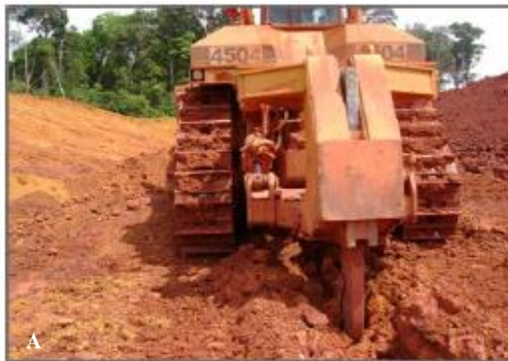
Figura 13 – Equipamentos realizando o desmonte mecânico do minério, dentro das operações de lavra propriamente dita.
