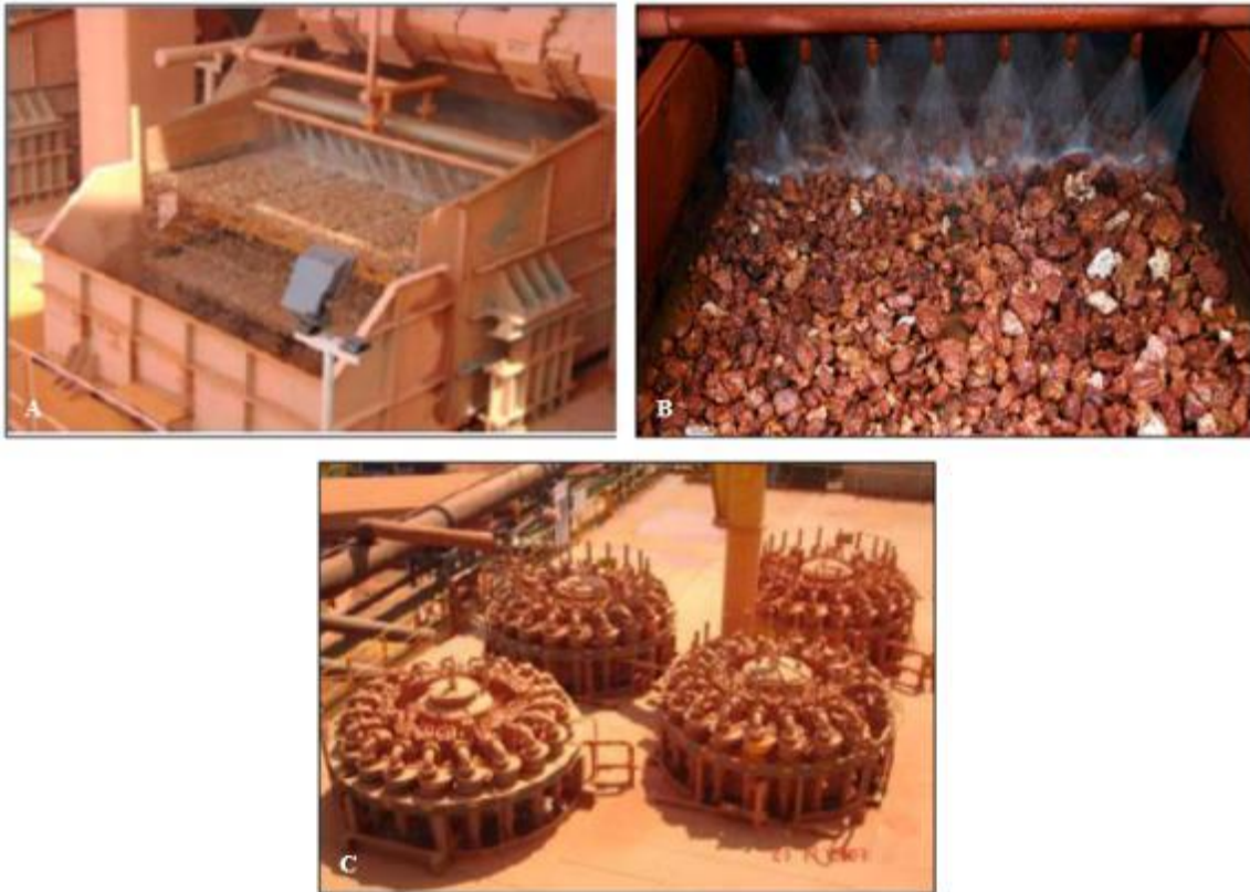
Figura 5.3-22. Registro fotográfico do funcionamento dos equipamentos que realizam as operações de peneiramento (A e B) e ciclonação (C).
