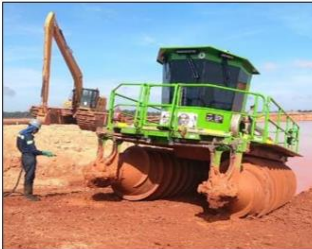
Figura 26 – “Mud Farming” em operação no SP-13, TSF-MRN (Nov.20)
