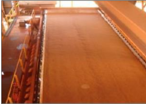
Figura 5.3-23. Registro fotográfico do funcionamento dos equipamentos que realizam as operações de filtragem.
