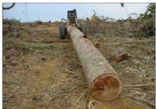
Figura 8 – Registro da operação de arraste da madeira com trator florestal.
