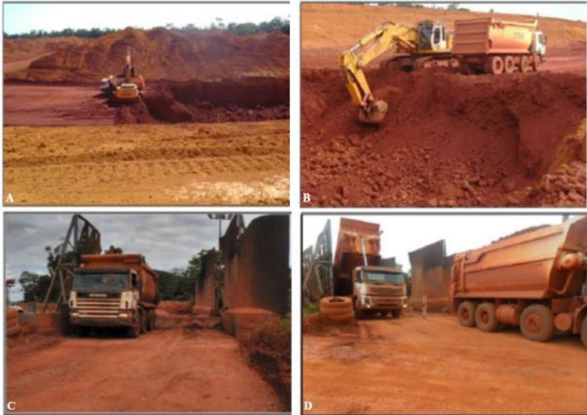
Figura 5.3-17. A e B) Carregamento de Minério em caminhões de pequeno porte para transporte até a instalação de beneficiamento de minério; C e D) registro do basculamento realizado por sobre o britador.
