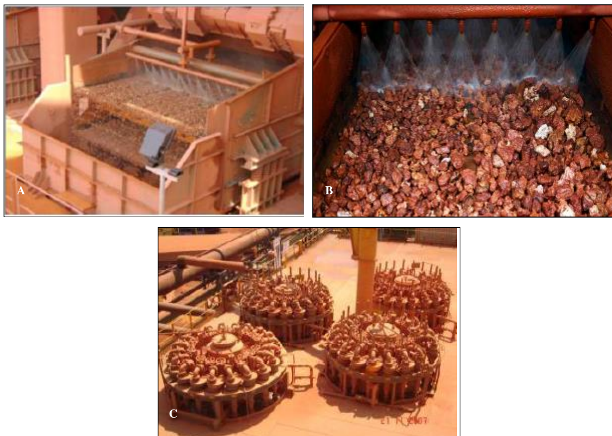
Figura 19 – Registro fotográfico do funcionamento dos equipamentos que realizam as operações de peneiramento e cicloneamento.
