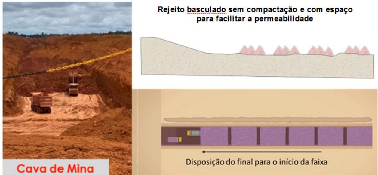
Figura 61 – Ilustração esquemática da disposição de rejeito em fundo de cava
