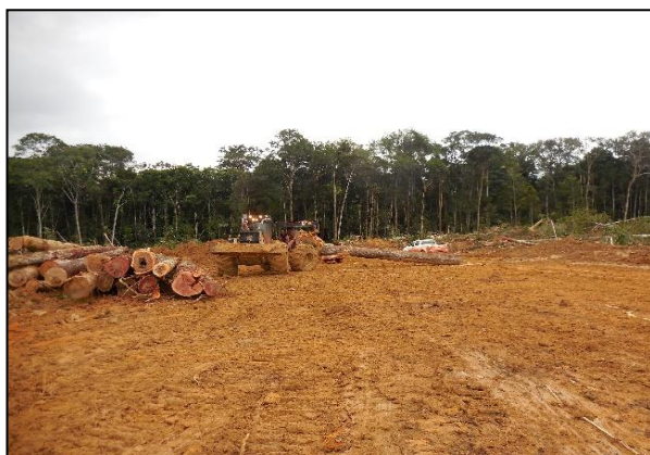
Figura 8 – Registro da operação de arraste da madeira com trator florestal.
