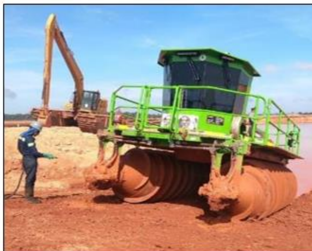
Figura 85 – “Mud Farming” em operação no SP-13, TSF-MRN (Nov.20)
