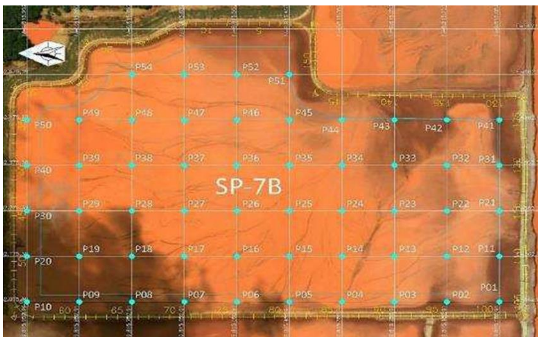
Figura 40 - Pontos de investigação e amostragem – SP-7B
