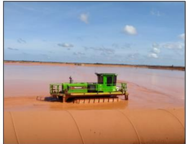
Figura 26 – “Mud Farming” em operação no SP-13, TSF-MRN (Nov.20)
