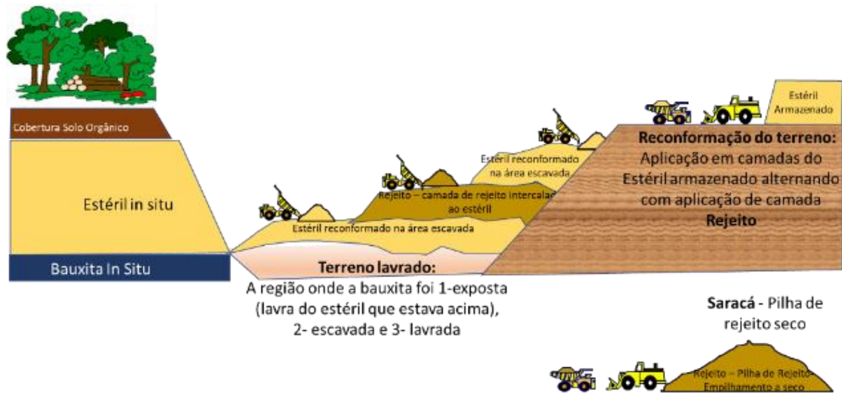
Figura 5.3-80. Metodologia de disposição de rejeito em cava.
