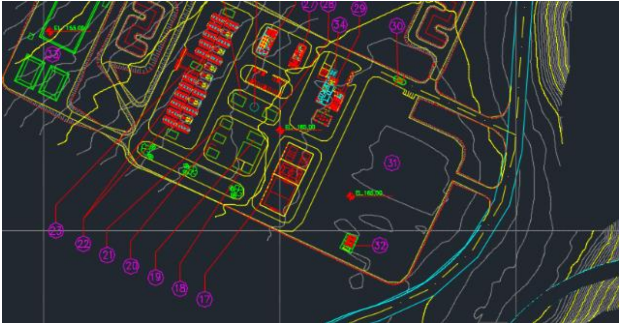
Figura 5.3-49. Layout das instalações provisórias na área Jamari.
