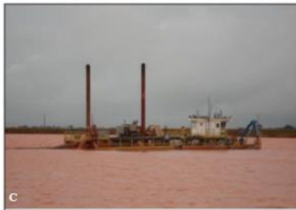
Figura 5.3-25. Tanque de Rejeito. TP2, com registro da operação das dragas que atuam na retomada do rejeito sedimentado e adensado visando envio para os SP.
