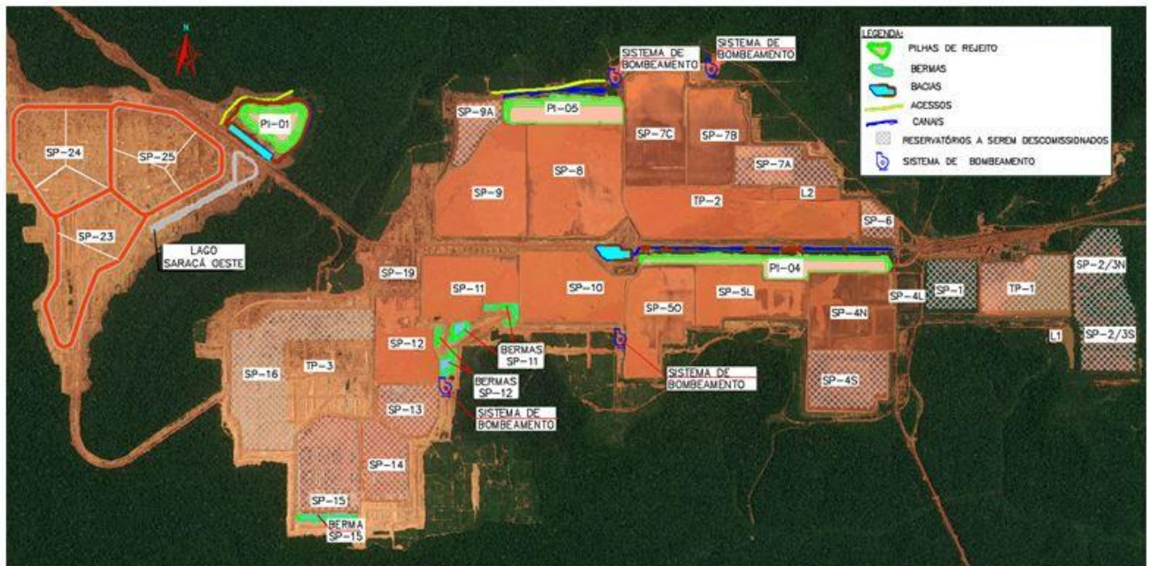
Figura 27 – Layout da expansão do sistema para a disposição de rejeito com a implantação de novos reservatórios e estruturas necessárias ao plano de produção de 12,5 Mtpa – 2021 a 2042
