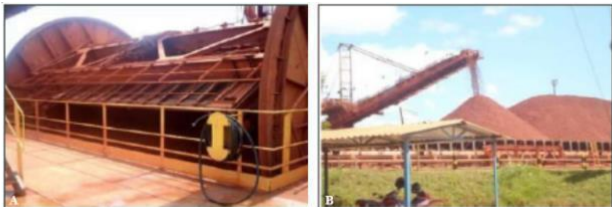
Figura 5.3-31. A) Car Dumper com descarregamento de bauxita sobre as correias transportadora e; B) Posterior direcionamento para empilhamento.
