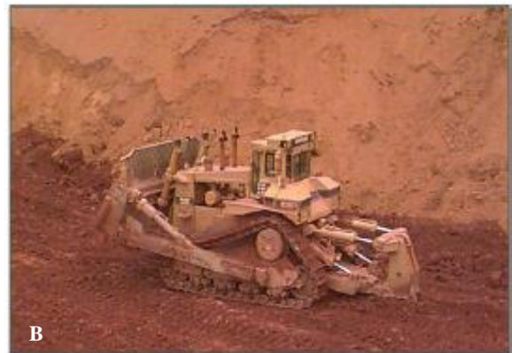
Figura 13 – Equipamentos realizando o desmonte mecânico do minério, dentro das operações de lavra propriamente dita.
