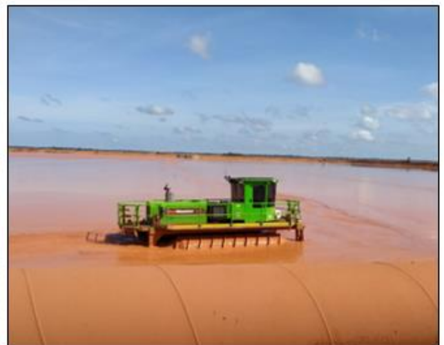
Figura 85 – “Mud Farming” em operação no SP-13, TSF-MRN (Nov.20)
