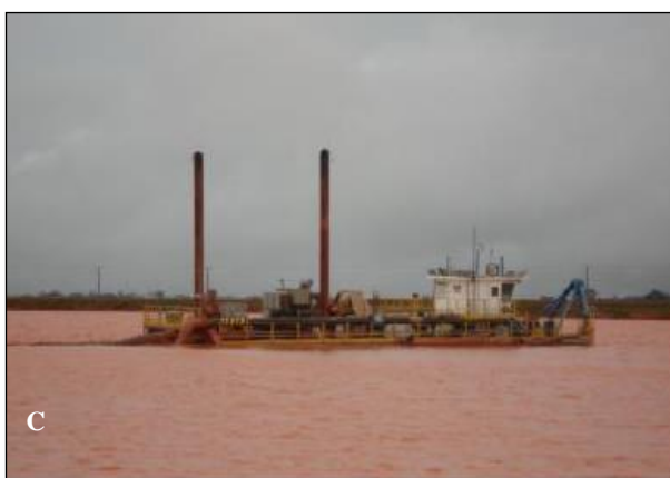
Figura 22 – Tanque de Rejeito – TP2, com registro da operação das dragas que atuam na retomada do rejeito sedimentado e adensado visando envio para os SP's.
